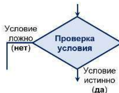
Рис. 3. Обозначение шагов для схемы разветвляющейся алгоритмической конструкции
